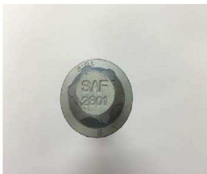
Oznaczenie SAF oryginalnej śruby sześciokątnej SAF, zawierające numer części 2801. Klasa wytrzymałości (10.9) jest również określona na łbie śruby.
