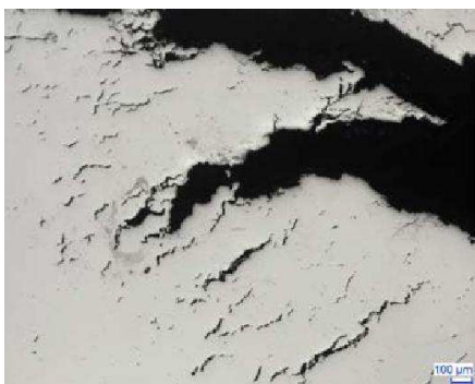
Mikropęknięcia dookoła łba nieoryginalnej śruby sześciokątnej.
