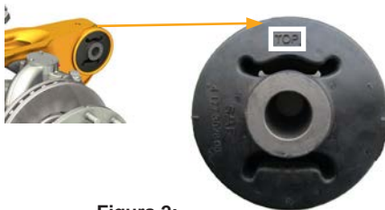
Figura 2: Posição de Montagem; inscrição TOP para cima.
