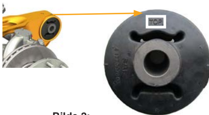
Bilde 2: Følg "TOP" merkingen på foringen for riktig monteringsposisjon.
