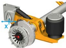
Bilde 1: Leddets elastitet: x = \pm 14 mm, 28 mm totalt
