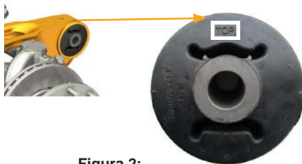
Figura 2: Posizione di montaggio Attenzione all'indicazione "TOP"
