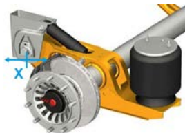
Figura 1: Elasticità articolare: x = \pm 14 mm, totale 28 mm
