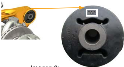
Imagen 2: Posición de montaje indicativo "TOP "
