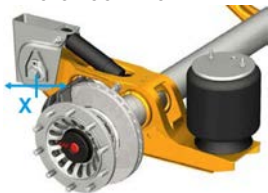
Изобр. 1: Еластичност на връзката: x = \pm 14 мм, общо 28 мм
